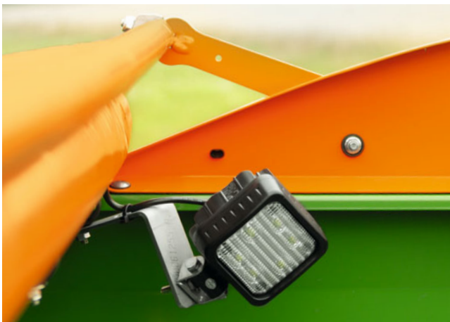
Внутреннее освещение бункера
