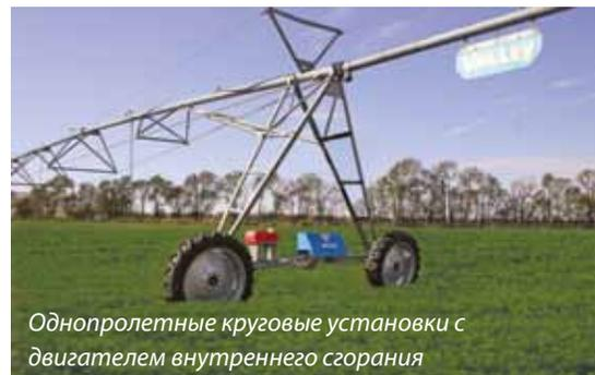
Однопролетные круговые установки с двигателем внутреннего сгорания
