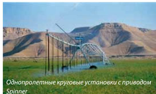
Однопролетные круговые установки с приводом Spinner
