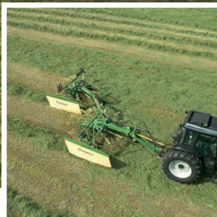
Укладка двух валков Два валка из 6,80 м
