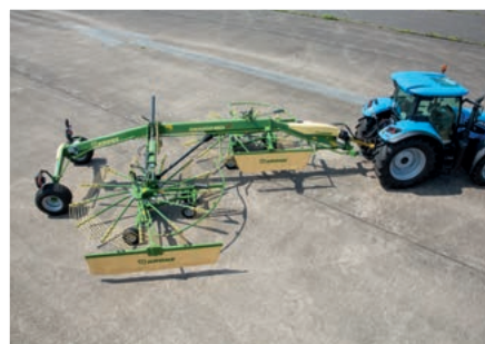
Swadro TS 740 Twin Ширина захвата 7,40 м / (2x 4,10 м)
