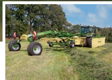
Swadro TS 680 Twin Ширина захвата 6,80 м / (2x 3,80 м)
