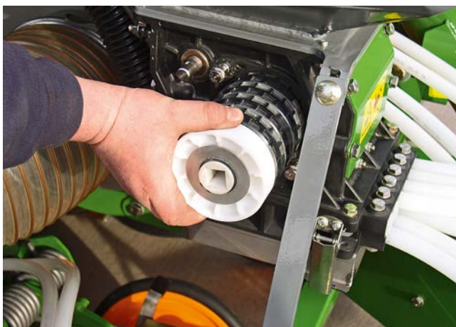
Замена дозирующей катушки
