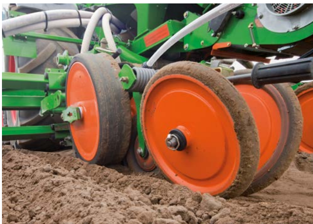
Опорные катки и закрытие борозды прикатывающим катком Super-V
