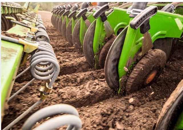
Сошник RoTeC pro с прикатывающей балкой в работе
