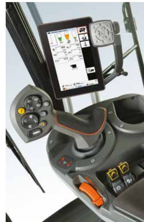
Вид оператора на основные органы управления
