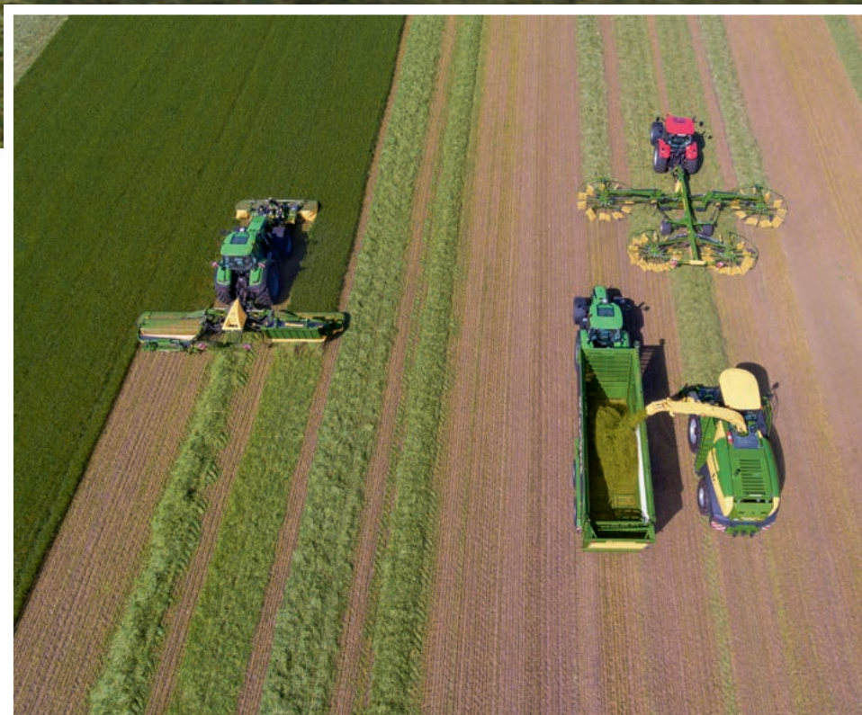
Четырехроторные валкователи с центральной укладкой валка Swadro TC 1370 Изменяемая ширина захвата от 10,80 м до 13,70 м
